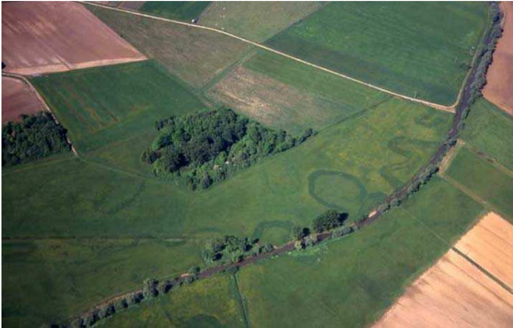
Figure 16 – Exemple de rectification de cours d'eau en zone rurale (photo JR Malavoi)
