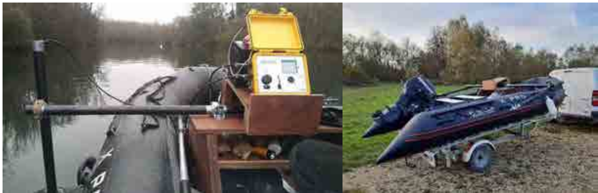
Figure 9. La photo de gauche montre le dispositif de suivi mobile en fonctionnement avec en fond la bouée d'un récepteur fixe, celle de droite montre le dispositif avant déploiement.
