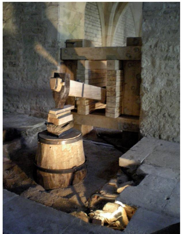
Figure 19 : Marteau hydraulique reconstitué à la forge de l'abbaye de Fontenay (2008).
