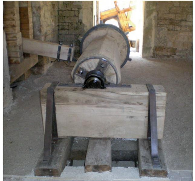
Figure 18 : Arbre du marteau hydraulique reconstitué à la forge de l'abbaye de Fontenay (2008).
