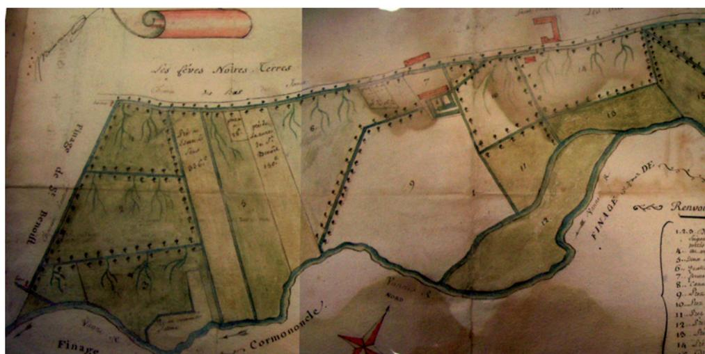
Figure 22 : Le réseau de canaux d'irrigation près de Saint-Benoist-sur-Vanne (Aube), d'après un plan du XVIII<sup>e</sup> siècle, Arch. dép. Aube, E 192. Le plan et le croquis montrent les canaux principaux et secondaires qui entourent les parcelles de pré et les « sangsues », petites rigoles qui permettent d'inonder les prairies en hiver et au printemps. Le long des canaux sont figurés des arbres. Les sources écrites attestent l'existence de ce réseau dès le XII<sup>e</sup> siècle.
