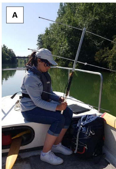
Annexe IV : A : Suivi mobile sur la Seine en bateau. Le récepteur se trouve dans le sac à dos posé aux pieds de l'opérateur. Il est relié à l'antenne qui détecte les signaux émis par les brochets marqués. B : Poste fixe installé au niveau de la frayère de Jaulnes que l'on aperçoit en arrière-plan.
